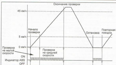
Диагностика датчиков системы ABS.
